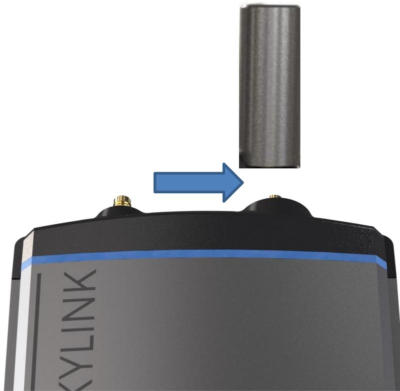
Conecte la antena MARUWA directamente al conector Iridium situado en el panel superior de la unidad.
