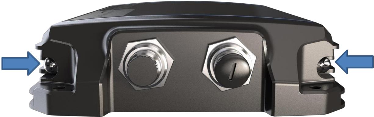
2. Inserte las tarjetas SIM ubicadas detrás del puerto de conectividad, teniendo cuidado de asegurar que los cables estén bien metidos.
