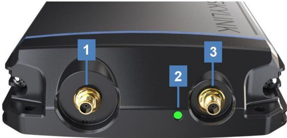
El panel superior contiene un indicador LED de alimentación y 2 conectores para una antena Iridium y celular. Las descripciones a continuación hacen referencia a la foto de arriba de acuerdo con el valor numérico.
