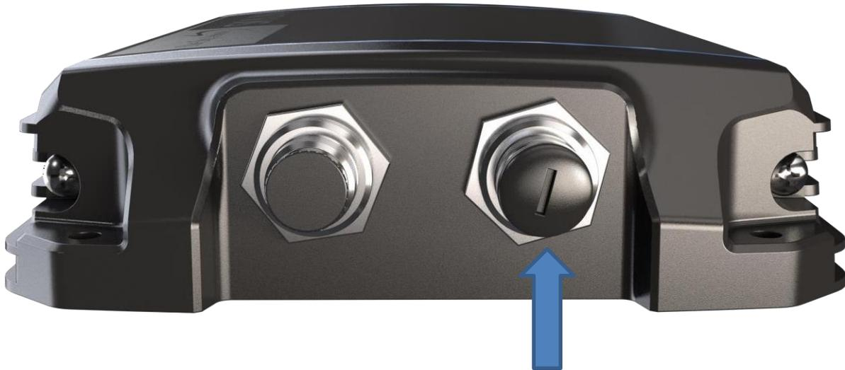
Para conectar el adaptador, retire la tapa del conector del puerto de conectividad ubicado en el panel inferior de la unidad. Conecte el cable al puerto y el adaptador al dispositivo apropiado (por ejemplo, en el módem o adaptador POTS).
