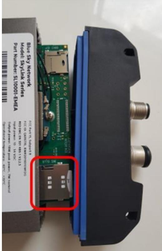
**NOTA:** También hay una ranura micro SD detrás del puerto de conectividad. Asegúrese de que las tarjetas SIM se coloquen en los soportes correctos y no en la ranura micro SD. Si el dispositivo no funciona después de instalar las tarjetas SIM, pueden estar en las ranuras equivocadas.
