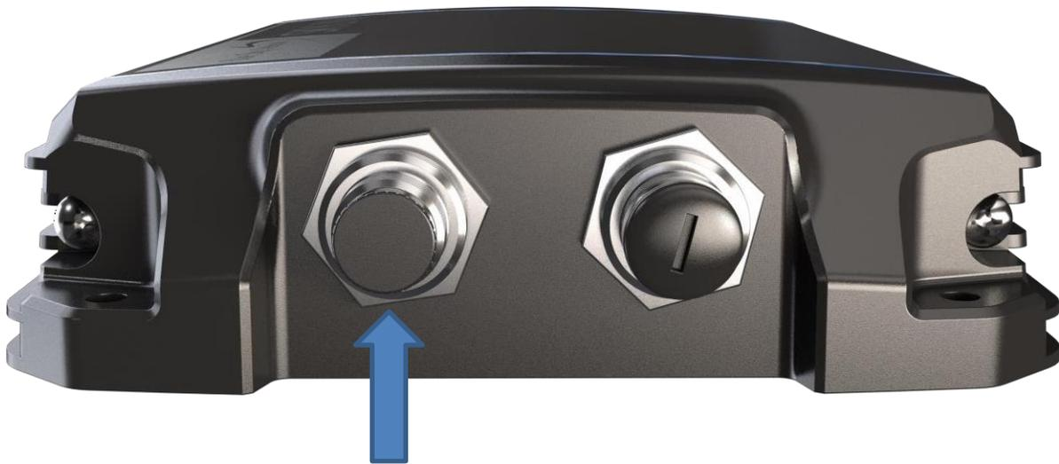
Para encender el dispositivo, retire la tapa del conector del puerto de alimentación ubicado en el panel inferior de la unidad. Conecte el cable de alimentación al puerto y el adaptador a la fuente de alimentación adecuada (por ejemplo, un tomacorriente de pared o de un vehículo).
